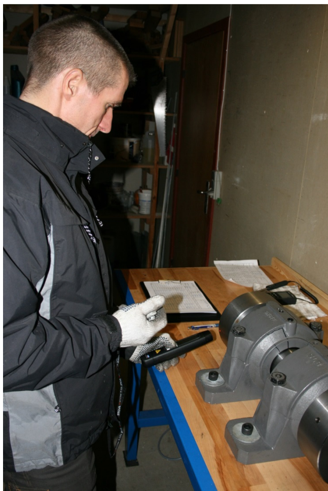
Figur 5.5. Kim B. Knudsen måler nedkøringstid på 6318 prøvestanden
