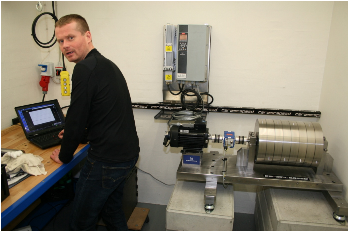
Figur 5.8. Jacob Csizmadia ved prøvestanden for 6205 lejer, monteret med 200 kg roterende vægt. Prøvestanden kunne også udstyres med en vægt på 9,2 kg
