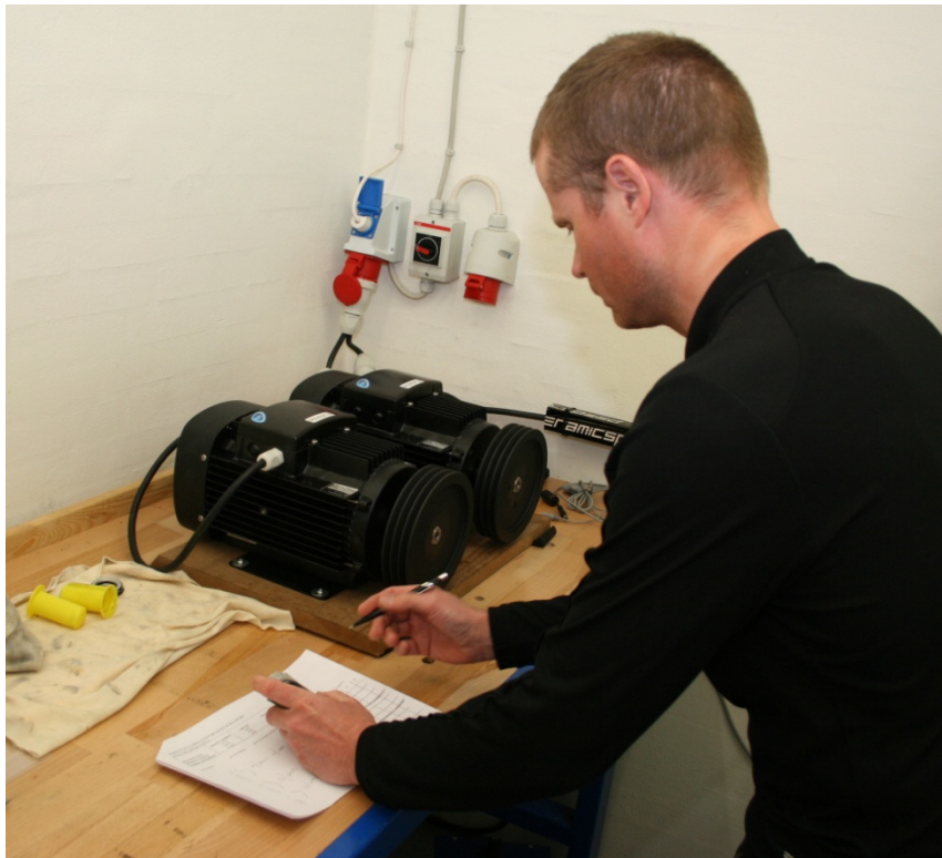
Figur 5.9. Måleopstilling med to ens motorer med forskellige lejetyper
