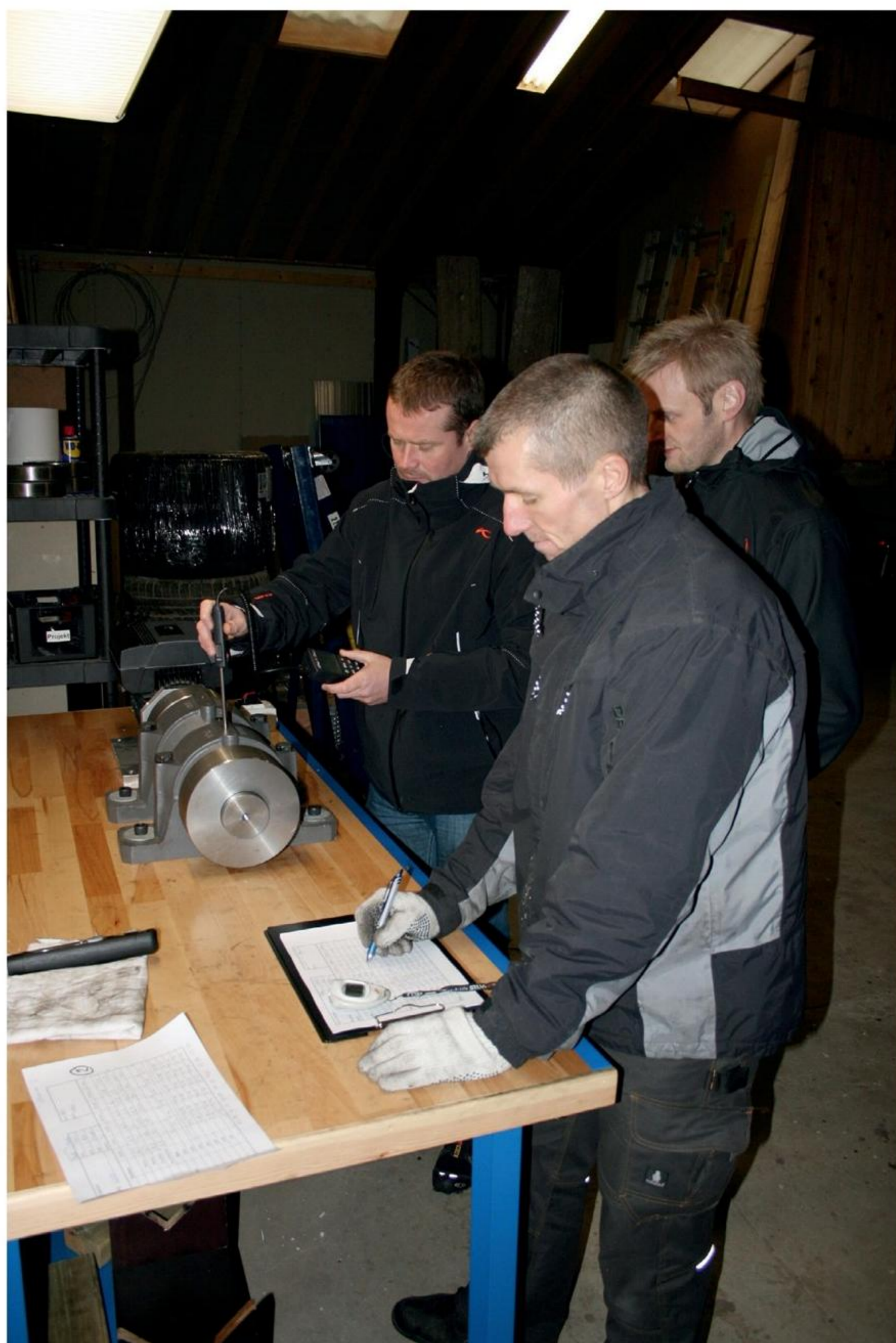
Afprøvning af lejerne i teststanden med måling af temperaturen.
